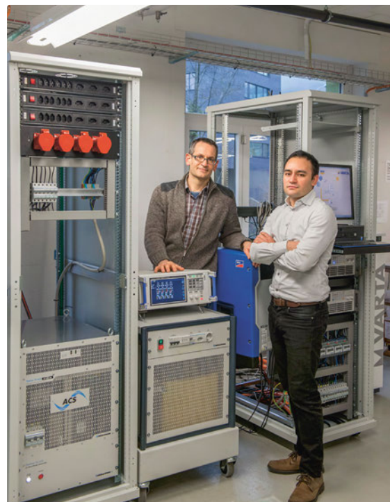
Stolz präsentieren Dr. Benno Züger (links) und Dr. Alejandro Santis (rechts) ihre Testumgebung. Diese ermöglicht, das Zusammenspiel von Komponenten wie Energiemanager und Solarstromspeicher in einer realitätsnahen Umgebung beschleunigt zu testen. (Foto: Efficiencie 21)
