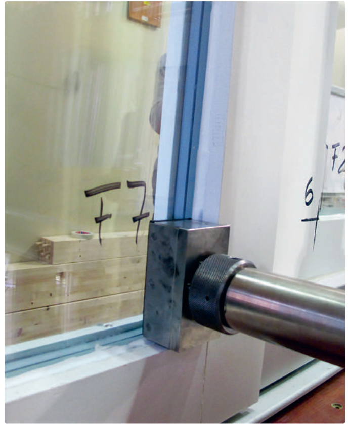
Abbildung 3: Prüfstempel bei der statischen Prüfung einer transparenten Füllung
