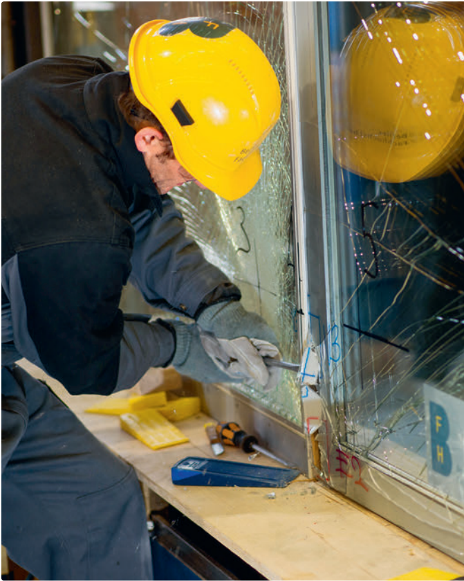
Abbildung 2: Manuelle Prüfung eines Türelements
