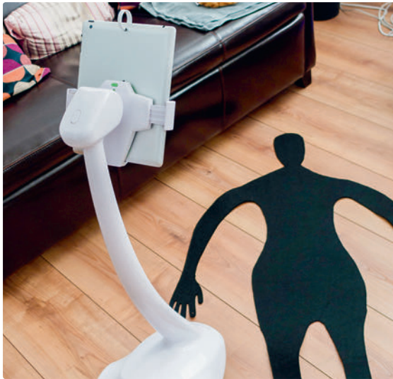
Abbildung 2: Über den Fussboden spannt sich ein elektrisches Feld. Dieses registriert, wenn Frau Brönnimann hinfällt, und alarmiert die Spitez.
