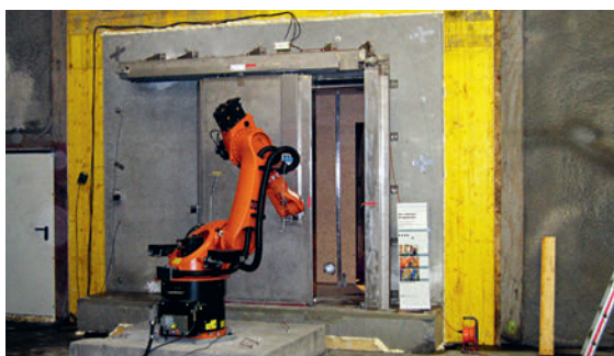
Test der Öffnungs- und Schliessfunktion an einer Querschlagtüre.
