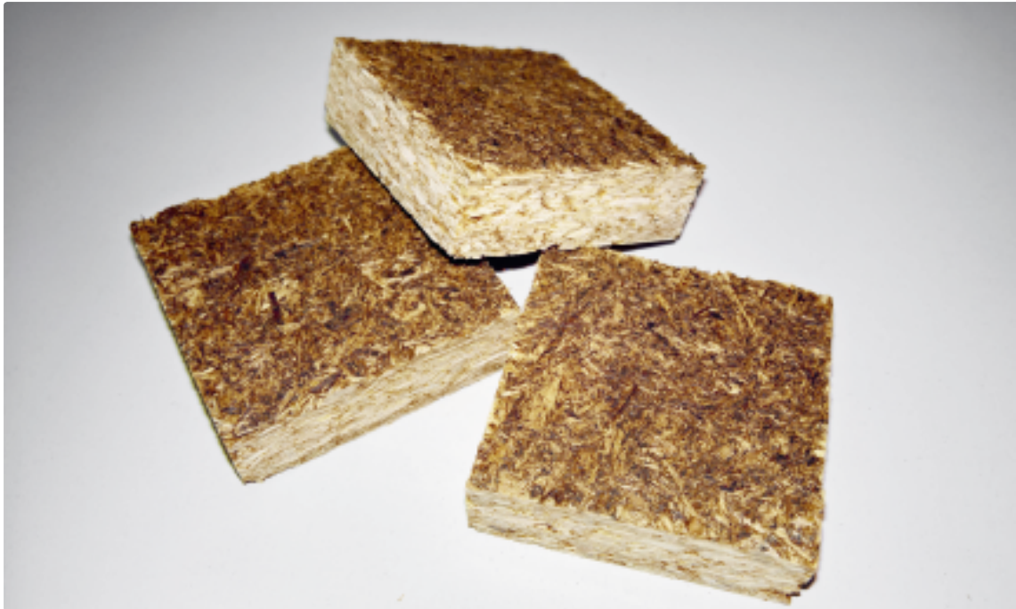
Abbildung 3: Muster von Spanplatten, behandelt mit Aminoharz, das aus HMF hergestellt wurde
