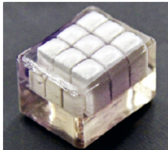
Laserinduzierte lokale Kristallisation in einer Glaskeramik
