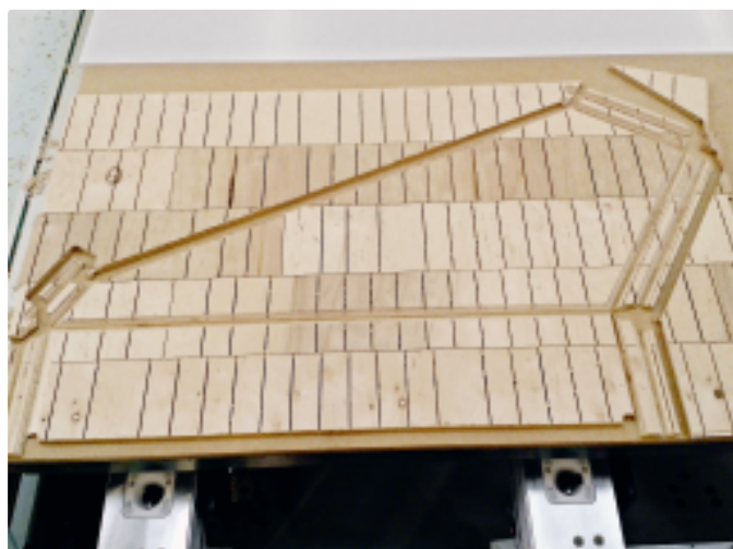
Résultat du fraisage final sur machine CNC
