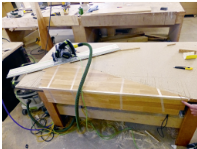
Processus actuel de découpe avec outillage électroportatif
