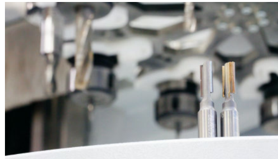
Werkzeuge mit DP-Schneiden – vor und nach der Anwendung
