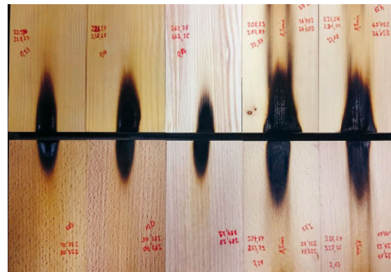
Mineralisierte Proben (oben Tanne, unten Buche) nach dem Brandversuch im Vergleich mit unbehandelten Proben (rechts).
