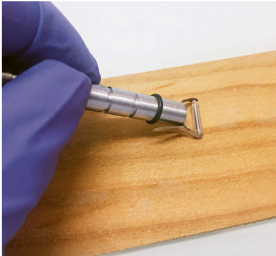
Abrollen einer Materialoberfläche mit einem Sammler zur Absorption der Pestizide für die Analytik
