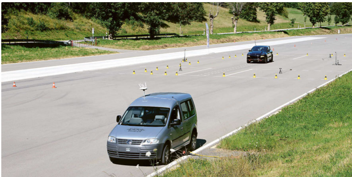
Bild 2: Geräuschmessung nach ECE-R-51.3, der neuen Norm zur Reduktion der Innerortgeräusche sowie zur Vorbeugung gegen Zykluserkennung und damit gegen Manipulationen, auf der Prüfstrecke des DTC in Vauffelin
