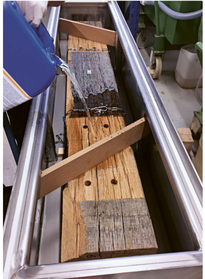
Traverse de chemin de fer en cours d'imprégnation au laboratoire de la BFH.
