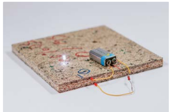
Abb. 4: Dreischichtige Spanplatte mit stromleitenden Deckschichten und LED in Einschraubfassung
